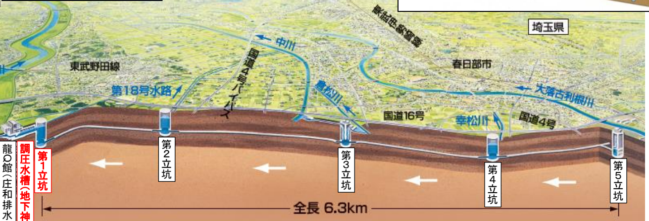
首都圏外郭放水路 全体イメージ
